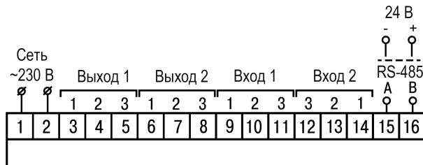
Рисунок 5.7 – Общая схема подключения 2TPM1–Н
