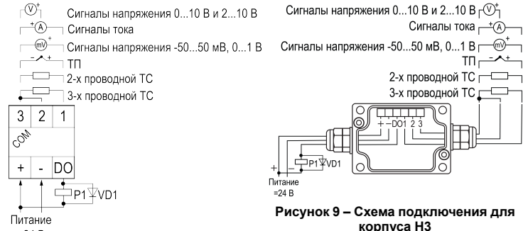
Рисунок 8 – Схема подключения для корпуса Щ9
