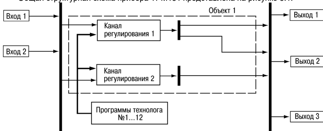
Рисунок 3.1 – Структурная схема прибора TPM151
