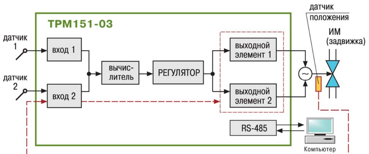
Рисунок 4.3 – Принципиальная схема модификации 03 прибора TPM151
