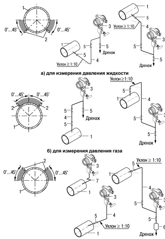
1 – трубопровод; 2 – отводная трубка; 3 – ПД100И с вентильным блоком; 4 – соединительная линия; 5 – запорный вентиль; 6 – сосуд сбора конденсата; 7 – одновитковая импульсная трубка
