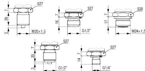
Рисунок 2 – Присоединительные размеры (место Б – зона штуцера)
