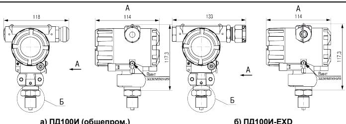
Рисунок 1 – Габаритные размеры
