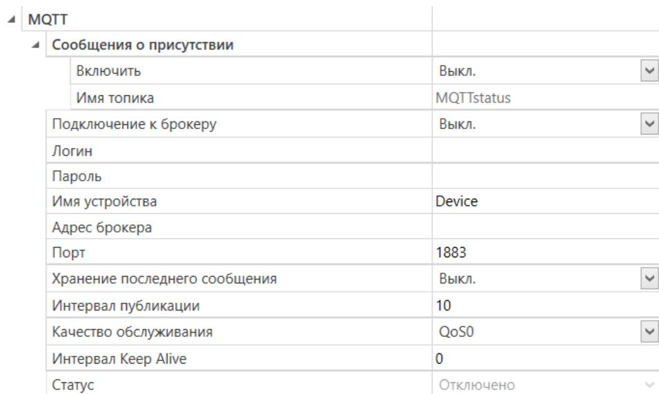
Рисунок 7.4 – Параметры обмена по MQTT
