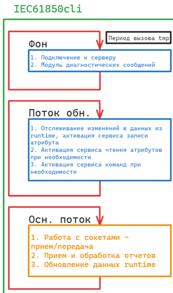
Рисунок 2.12 – Работа IEC61850cli: разделение на потоки и последовательность вызова подпрограмм
