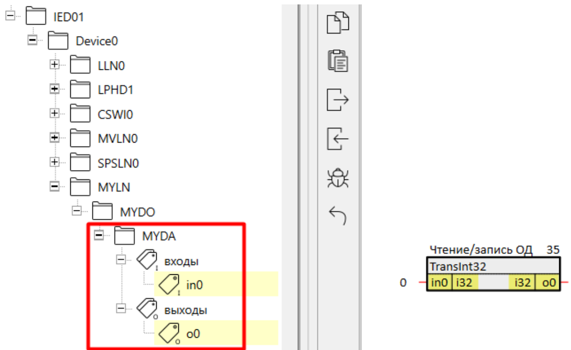
Рисунок 3.16 – Связь атрибута данных с TransInt32
