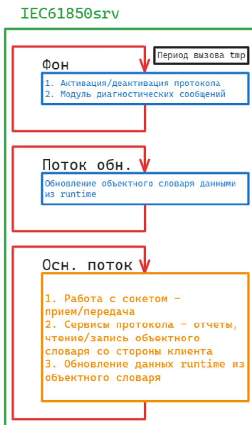
Рисунок 2.5 – Работа IEC61850srv: разделение на потоки и последовательность вызова подпрограмм
