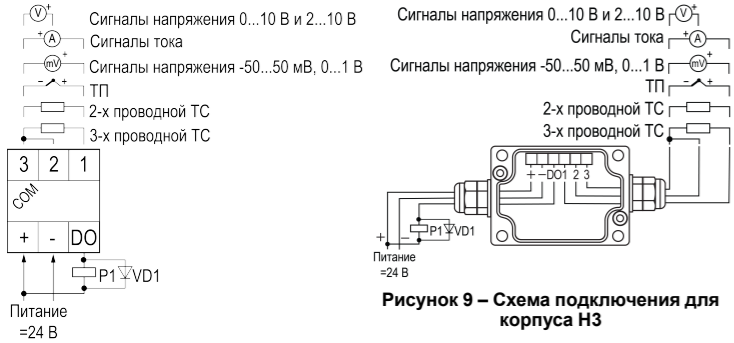
Рисунок 8 – Схема подключения для корпуса Щ9
