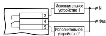
Рисунок 16 – Схема подключения нагрузки к ВУ типа Р
