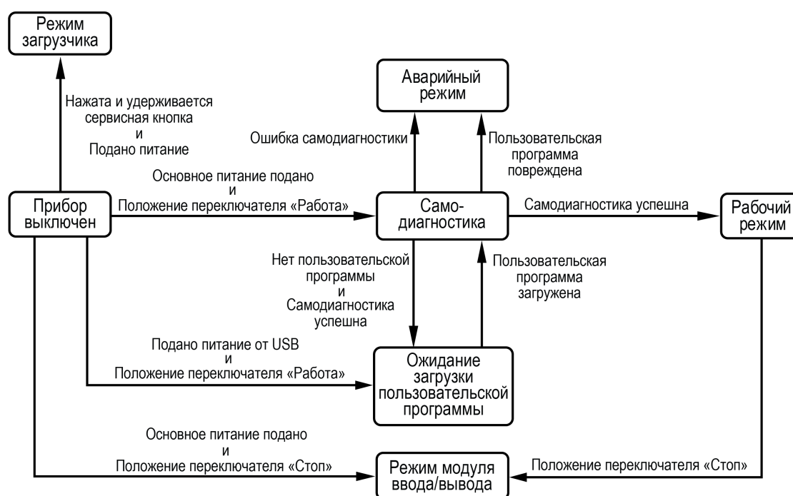
Рисунок 7.5 – Схема переходов между режимами работы
