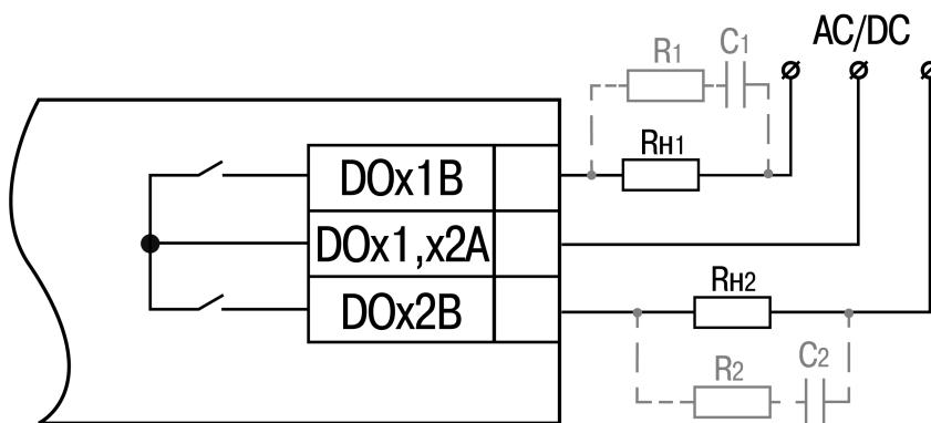
Рисунок 5.6 – Схема подключения к реле с общими контактами
