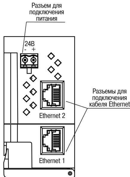
**Рисунок 5.2 – Разъемы прибора**
