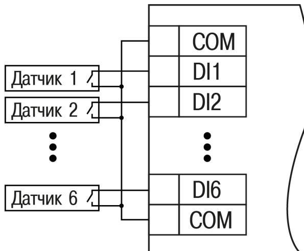
Рисунок 5.4 – Схема подключения к входам DI1–DI6
