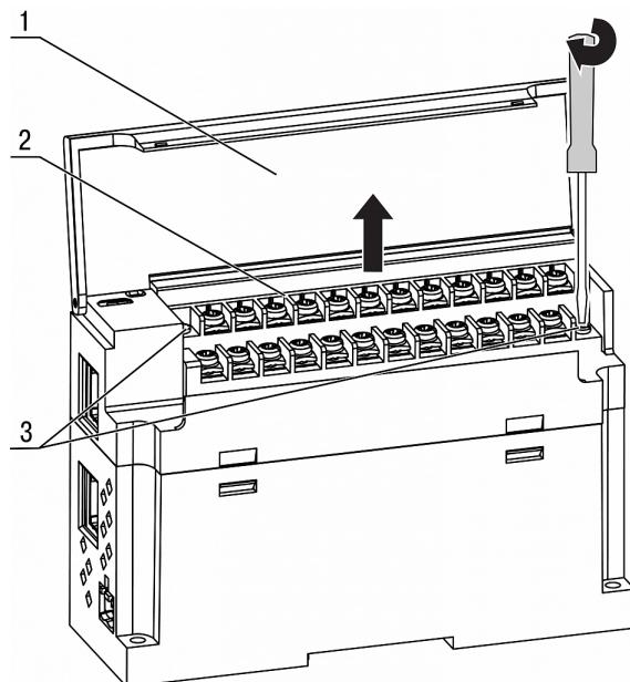
Рисунок 8.1 – Отсоединение клемм
