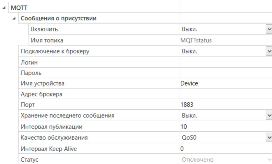
**Рисунок 7.4 – Параметры обмена по MQTT**
