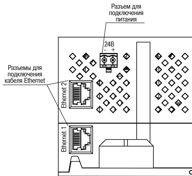
Рисунок 5.2 – Разъемы прибора
