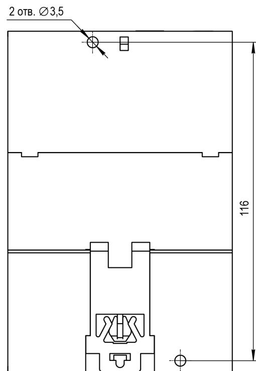
Рисунок 4.4 – Установочные размеры
