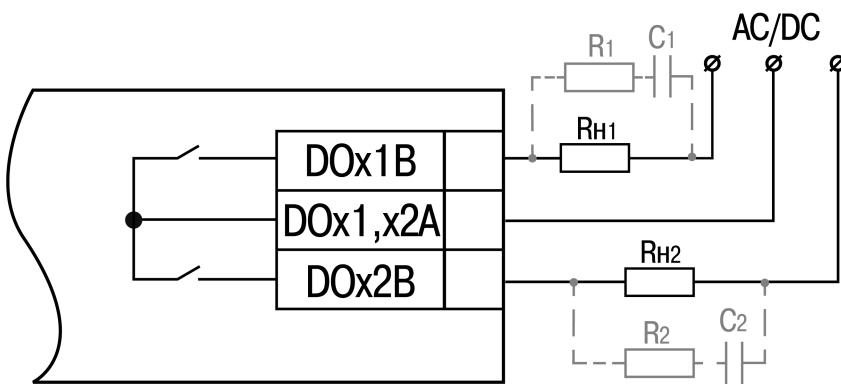
Рисунок 5.5 – Схема подключения к реле с общими контактами
