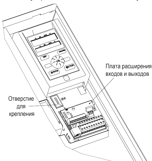
Рисунок 7.30 – Монтаж платы расширения входов и выходов
