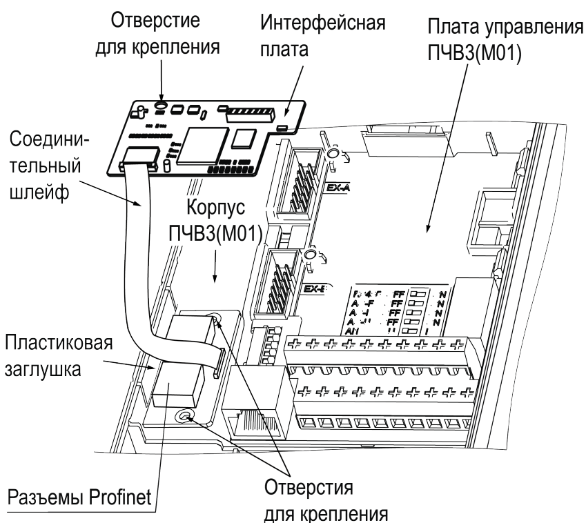
Рисунок 7.21 – Монтаж платы на преобразователях частоты мощностью 5,5 – 45 кВт
