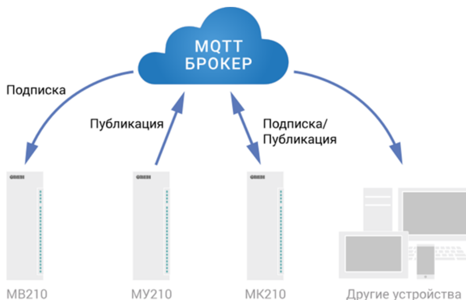
Рисунок 6.2 – Структурная схема обмена по протоколу MQTT
