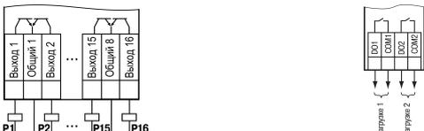
Рисунок 9 – Подключение нагрузки к выходу типа «КТ»
