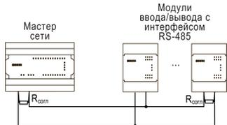
Рисунок 12 – Типовая схема подключения в режиме Master
