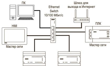
Рисунок 13 – Подключение по схеме «Звезда»
