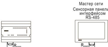
Рисунок 11 – Типовая схема подключения в режиме Slave
