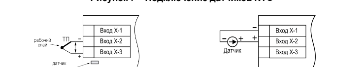
Рисунок 8 – Схема подключения термопары Рисунок 9 – Схема подключения пассивного датчика с выходным сигналом силы постоянного тока от 0 до 5 мА или от 0(4) до 20 мА с питанием от прибора
