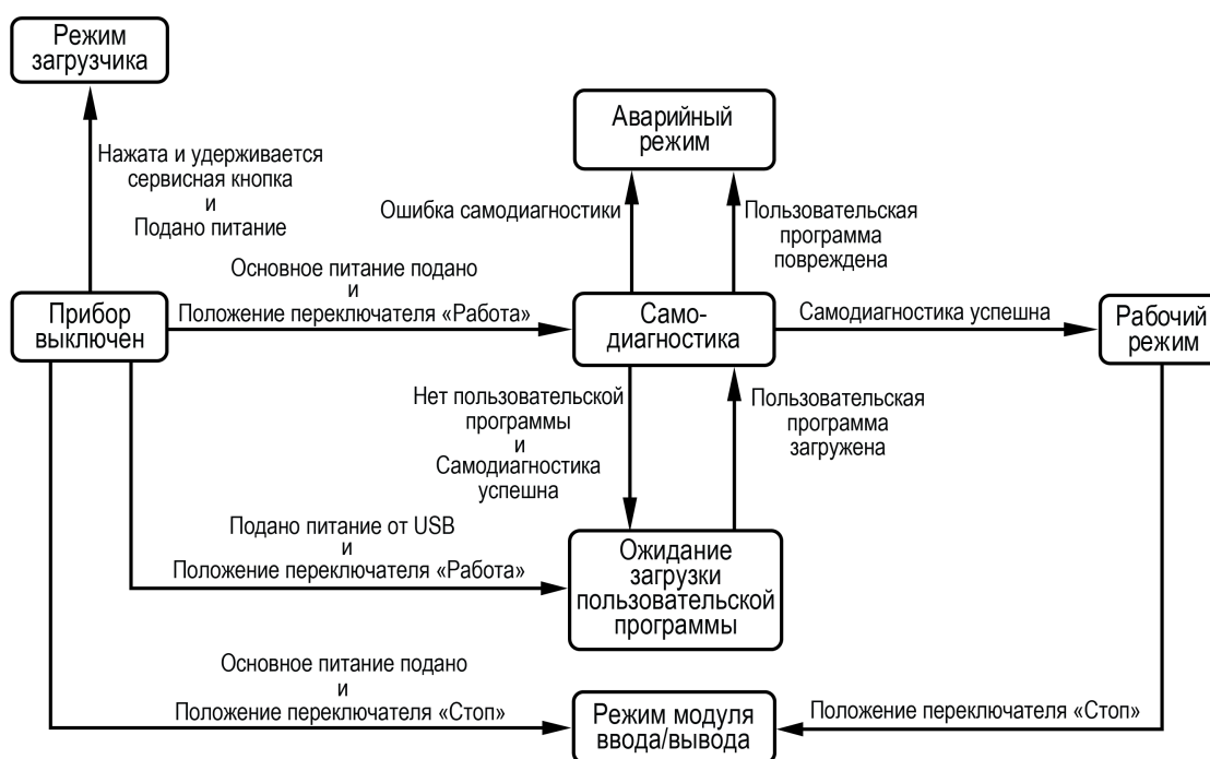
Рисунок 7.7 – Схема переходов между режимами работы
