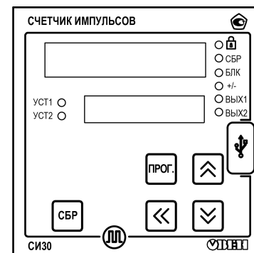
Рисунок 19 – Лицевая панель прибора для корпусов настенного Н и щитового Щ1 креплений
