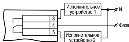
Рисунок 15 – Схема подключения нагрузки к ВУ типа Р
