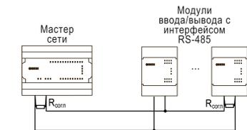
Рисунок 13 – Типовая схема подключения в режиме Master
