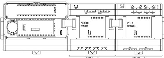
Рисунок 15 – Расположение модулей расширения на шине
