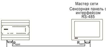
Рисунок 12 – Типовая схема подключения в режиме Slave
