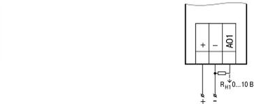
Рисунок 11 – Схема подключения нагрузок к ВЭ сигналов «0...10 В»
