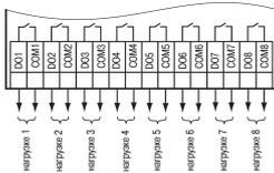
Рисунок 9 – Схема подключения нагрузок к ВЭ типа «Р»
