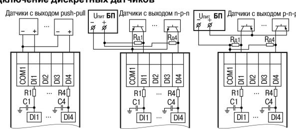
Рисунок 3 – Подключение к типу «Д»
