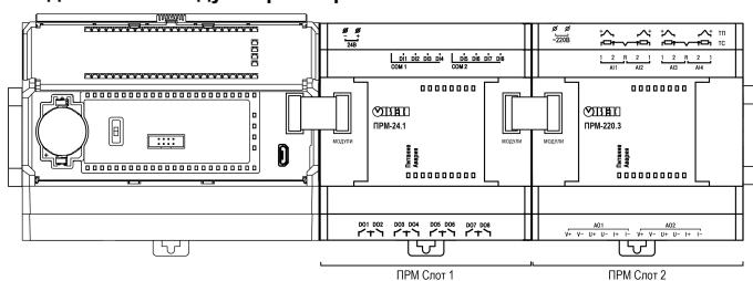
Рисунок 13 – Расположение модулей расширения на шине
