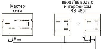
Рисунок 11 – Типовая схема подключения в режиме Master
