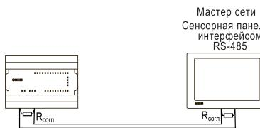
Рисунок 10 – Типовая схема подключения в режиме Slave
