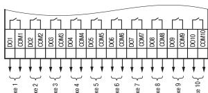
Рисунок 9 – Схема подключения нагрузок к ВЭ типа «Р»
