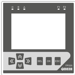
Рисунок 12 – Лицевая панель прибора (крышка справа показана в открытом положении)
