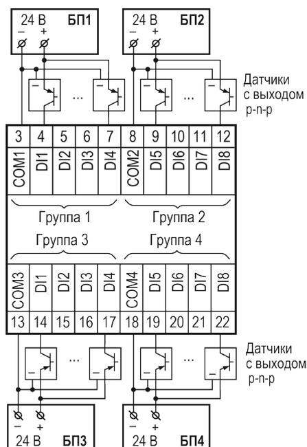
Рисунок 5.8 – Схема подключения датчиков с выходным транзистором р-п-р-типа
