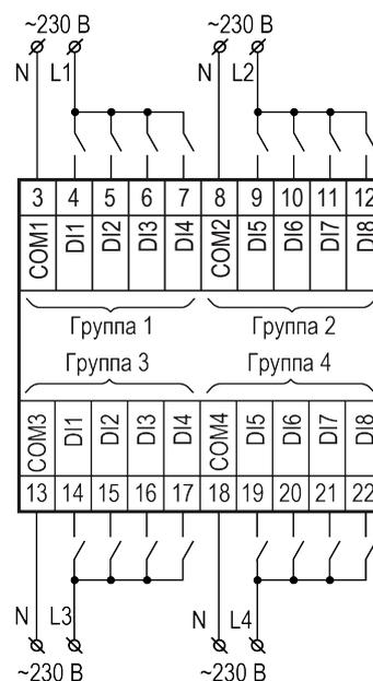
**Рисунок 5.7 – Схема подключения дискретных датчиков с питанием 230 В**
