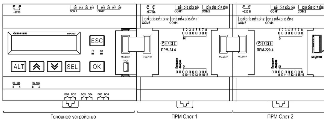
Рисунок 5.5 – Расположение модулей расширения на шине
