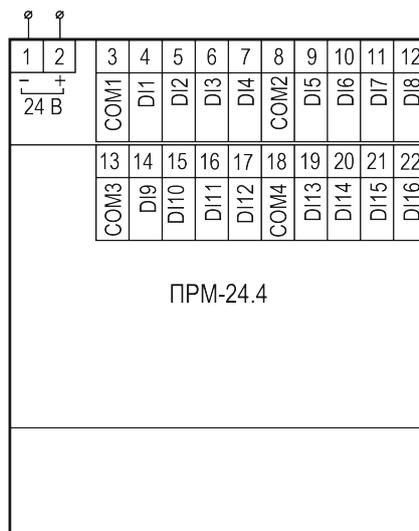
Рисунок 5.2 – Назначение контактов клеммника прибора с питанием 24 В
