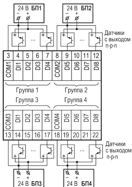
Рисунок 5.9 – Схема подключения датчиков с выходным транзистором п-р-п-типа
