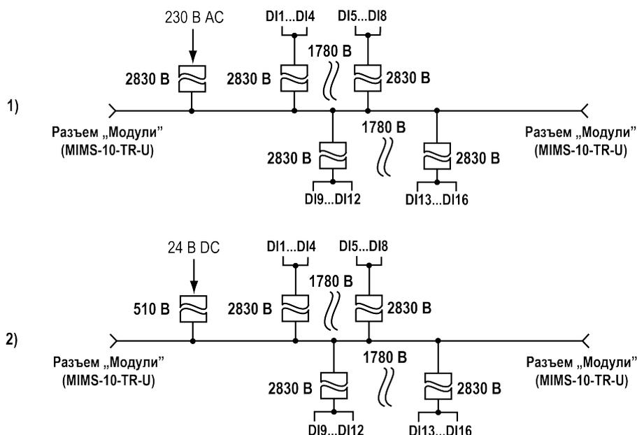
Рисунок 5.1 – Схемы гальванической развязки (1) 220 В и (2) 24 В модификаций
