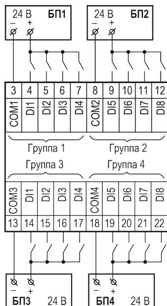
**Рисунок 5.6 – Схема подключения дискретных датчиков с питанием 24 В**
