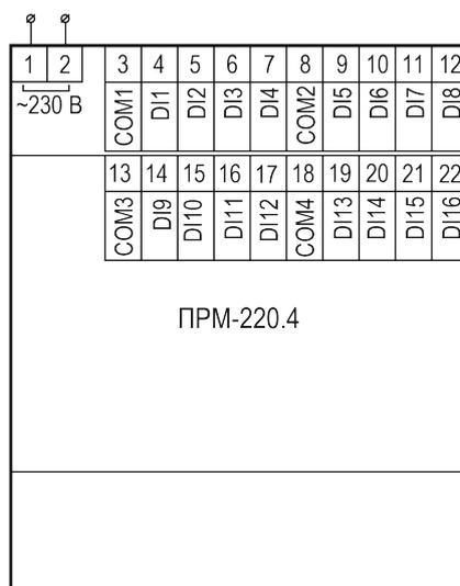
Рисунок 5.3 – Назначение контактов клеммника прибора с питанием 230 В
