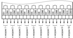
Рисунок 4 – Схема подключения нагрузок к ВЭ типа «Р»
