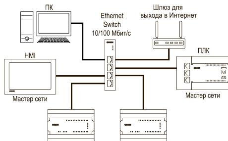
Рисунок 7 – Подключение по схеме «Звезда»
