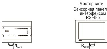
Рисунок 5 – Типовая схема подключения в режиме Slave
