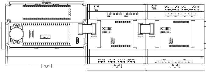
Рисунок 8 – Расположение модулей расширения на шине
