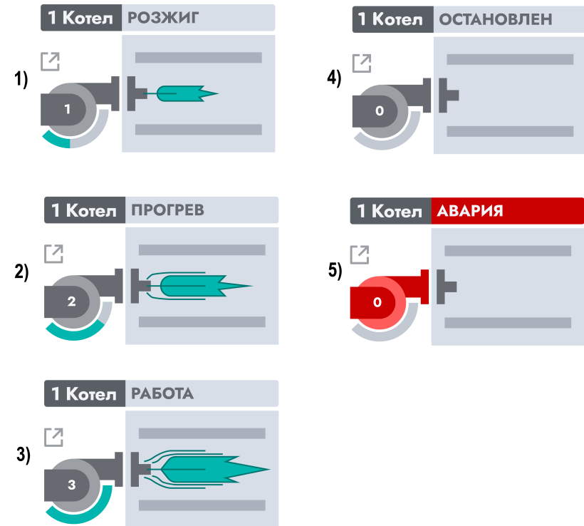
Рисунок 10.11 – Состояния горелки на примере трехступенчатой
