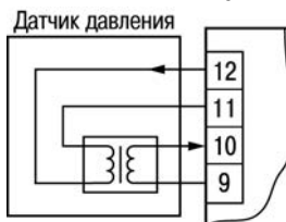
Рисунок Б.5 - Схема подключения датчика давления, выполненного на дифференциальном трансформаторе
