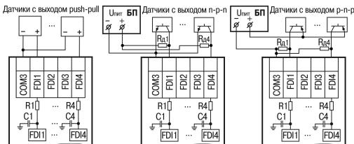
Рисунок 8 – Подключение к входам типа «ДС»
