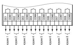
Рисунок 9 – Схема подключения нагрузок к ВЭ типа «Р»
