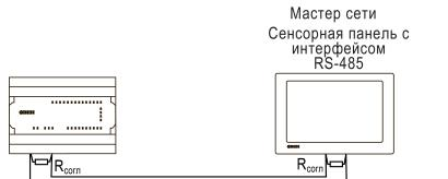
Рисунок 11 – Типовая схема подключения в режиме Slave
