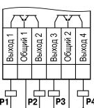
Рисунок 10 – Схема подключения нагрузок типа «КТ»
