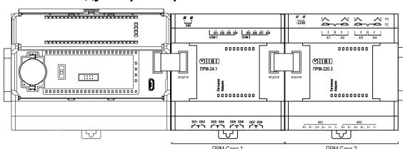
Рисунок 14 – Расположение модулей расширения на шине
