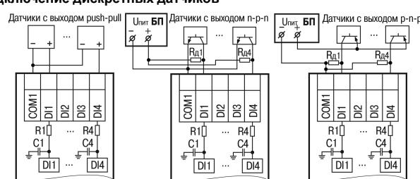
Рисунок 3 – Подключение к типу «Д»
