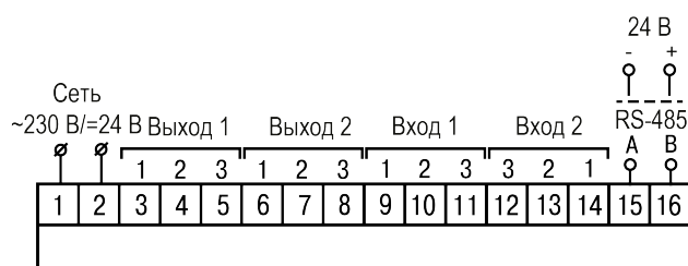
Рисунок 5.7 – Общая схема подключения TRM12–Н
