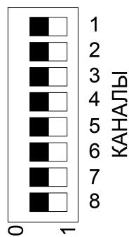
Рисунок 5.9 – DIP-переключатели на корпусе модуля для подключения резисторов
