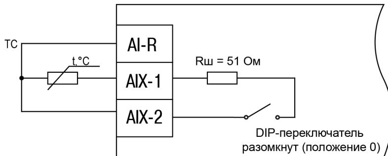
Рисунок 5.4 – Схема подключения ТС по трехпроводной схеме
