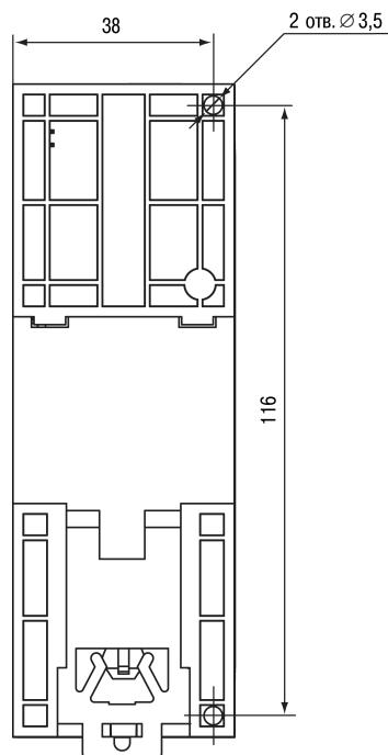
**Рисунок 4.4 – Установочные размеры**
