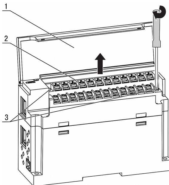
Рисунок 8.1 – Отсоединение клемм
