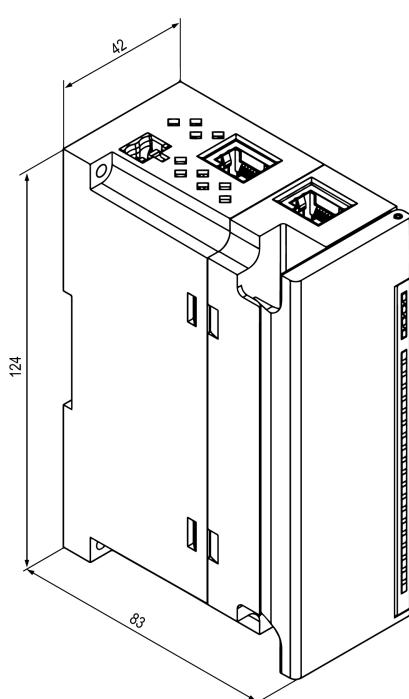
**Рисунок 4.3 – Габаритный чертеж**
