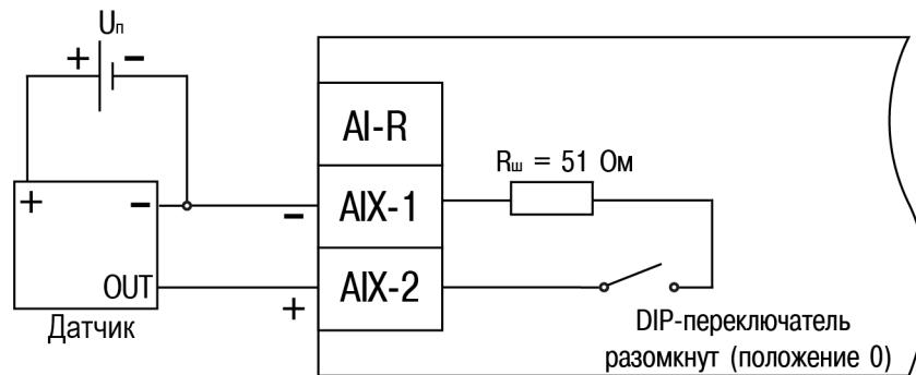
**Рисунок 5.6 – Схема подключения датчиков с унифицированным выходными сигналами постоянного напряжения  $-50\dots+50$  мВ и  $-1\dots+1$  В по трехпроводной схеме**
