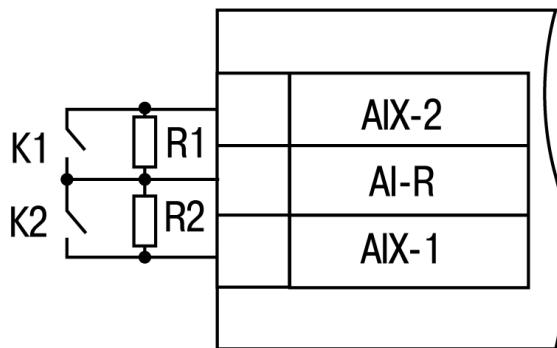
**Рисунок 5.11 – Схема подключения дискретных датчиков типа «сухой контакт»**
