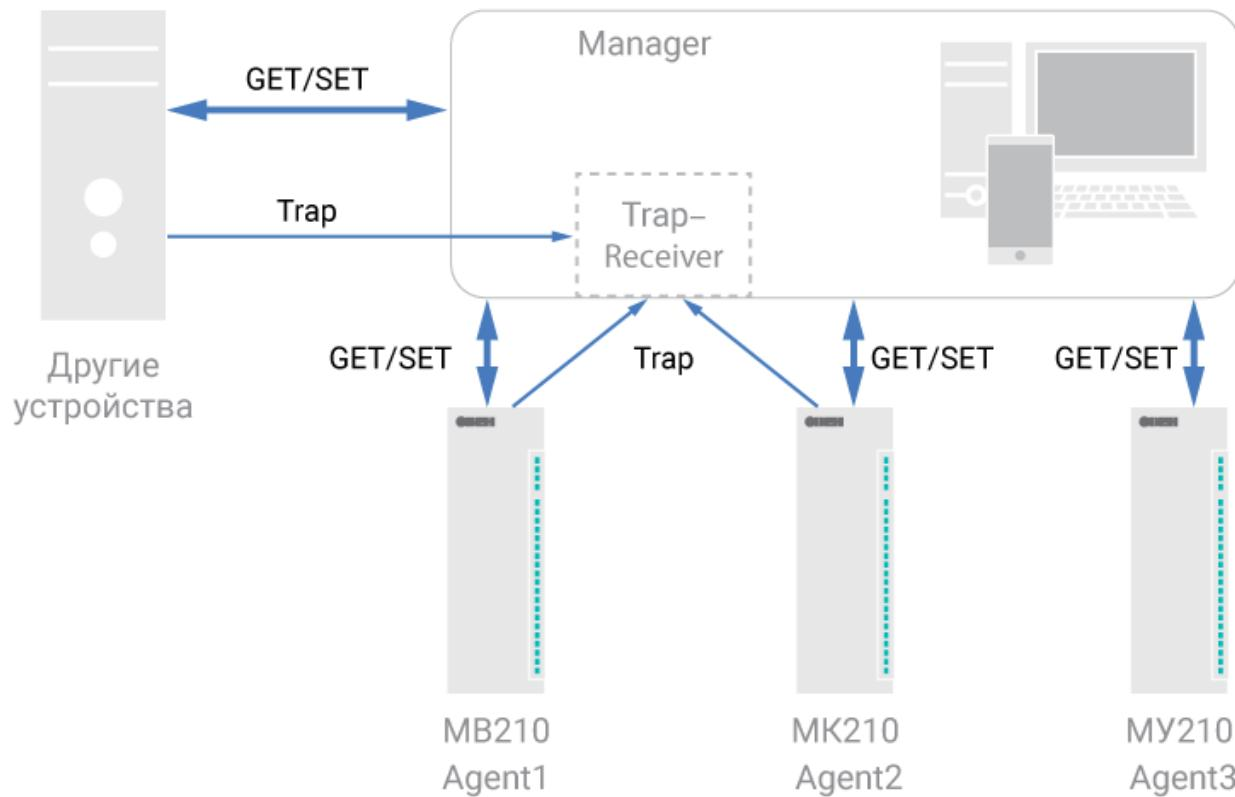
Рисунок 6.6 – Структурная схема обмена по протоколу SNMP
