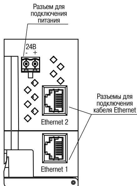
Рисунок 5.2 – Разъемы модуля
