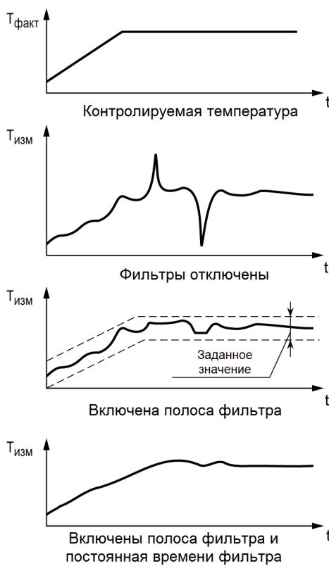
Рисунок 6.2 – Временные диаграммы работы цифровых фильтров
