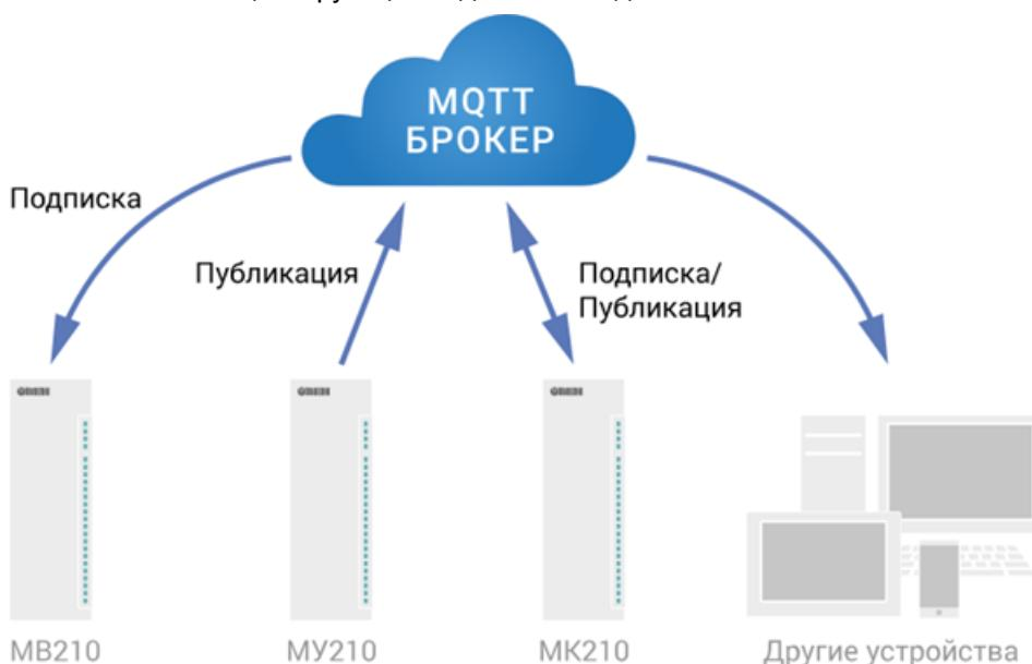
Рисунок 6.5 – Структурная схема обмена по протоколу MQTT
