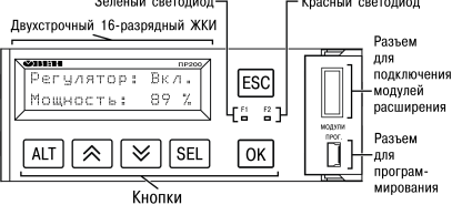
Рисунок 14 – Лицевая панель прибора (крышка отсека подключения модулей условно не показана)
