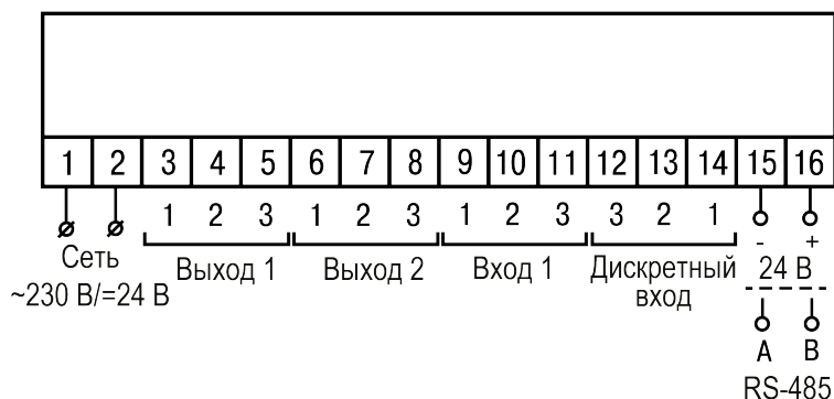
Рисунок 5.4 – Общая схема подключения TRM10–Щ1/Щ2
