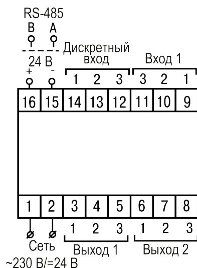
Рисунок 5.6 – Общая схема подключения TRM10–Д
