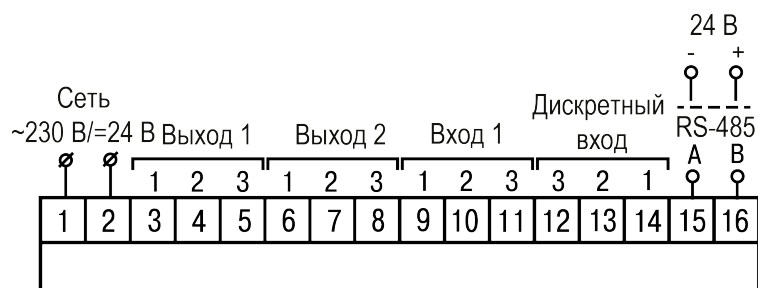
Рисунок 5.7 – Общая схема подключения TPM10–Н
