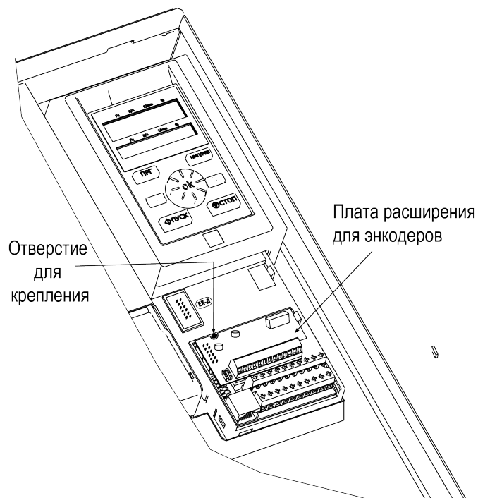
Рисунок 4.1 – Монтаж платы расширения для энкодеров
