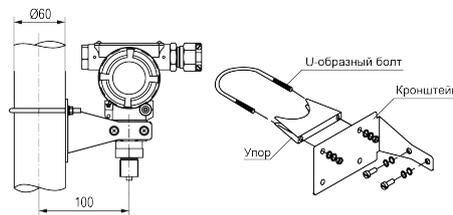
Рисунок 3 – Установка преобразователя на трубе
