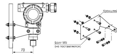
Рисунок 4 – Установка преобразователя на панели
