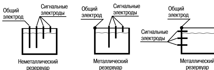
Рисунок 6.4 – Примеры установки кондуктометрических зондов
