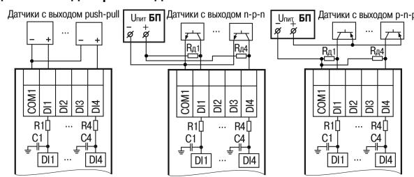
Рисунок 3 – Подключение к типу «Д»
