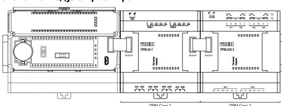
Рисунок 15 – Расположение модулей расширения на шине
