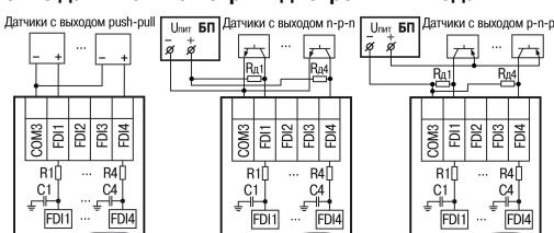
Рисунок 8 – Подключение к входам типа «ДС»
