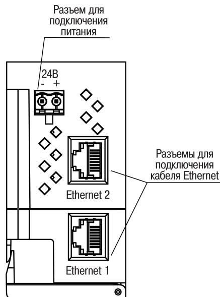
Рисунок 5.2 – Разъемы прибора
