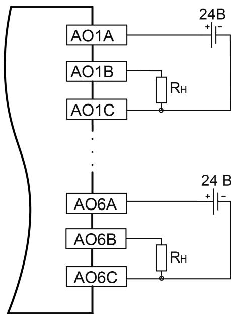
**Рисунок 5.4 – Схема подключения нагрузки к аналоговым выходам**
