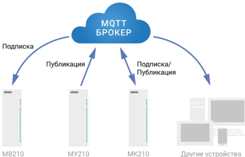
Рисунок 6.2 – Структурная схема обмена по протоколу MQTT
