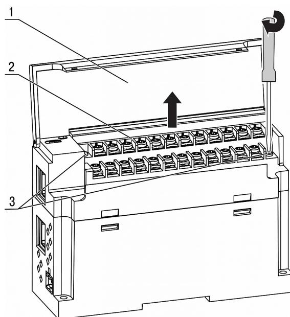
Рисунок 8.1 – Отсоединение клемм
