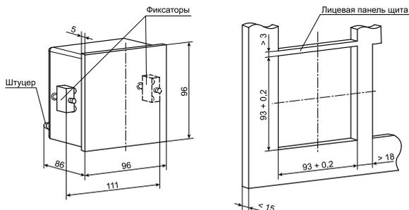
Рисунок 1 – Габаритные и установочные размеры преобразователя щитового крепления
