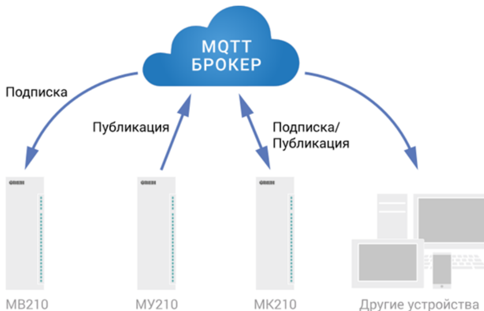
Рисунок 6.5 – Структурная схема обмена по протоколу MQTT
