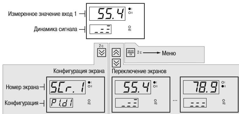
Рисунок 6.5 – Схема переходов с главного экрана
