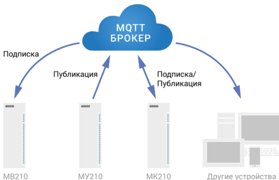
Рисунок 6.5 – Структурная схема обмена по протоколу MQTT
